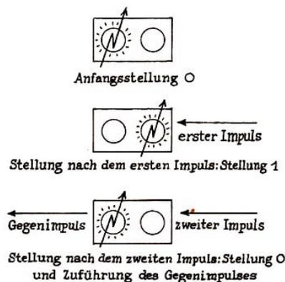
Als Anfangsstellung werde die Nullstellung gewählt. (Vergleichen Sie mit der vorstehenden Abbildung!) Der Strom fließt also durch die linke Röhre. Nach dem ersten Impuls wird der Strom durch die rechte Röhre fließen, d. h., der Trigger geht in die Stellung 1 über. Dabei geht vom Trigger kein Gegenimpuls aus, da der Gegenimpuls im Moment des Ausschaltens der rechten Röhre (und nicht der linken) ausgelöst wird.
