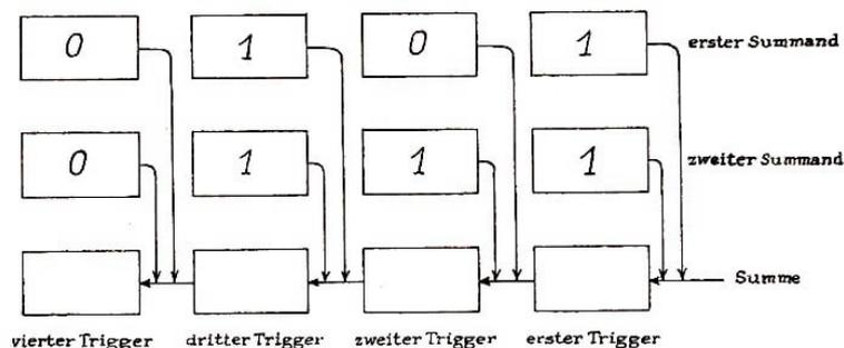
Drei Triggerketten seien so verbunden, wie es in der vorstehenden Abbildung angeführt ist. Die obere Triggerkette dient der Aufzeichnung des ersten Summanden, die zweite Kette der Aufzeichnung des zweiten Summanden, die untere Kette aber der Ermittlung der Summe.
