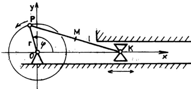
Abb. 5: Prinzip des Schubkurbelgetriebes
