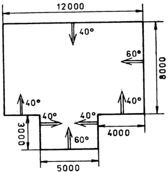
Abb. 2: Grundriß eines Daches mit Neigungswinkeln der Dachflächen
