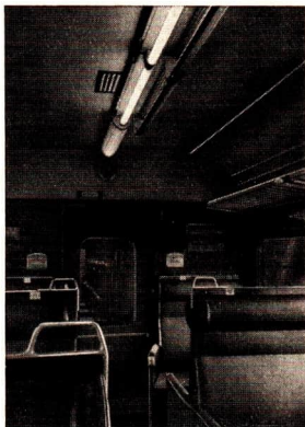
Abb. 6/1. Leuchtstoffröhren in einem D-Zug-Wagen der Deutschen Reichsbahn. Die vorderen beiden Schalen sind abgenommen.
