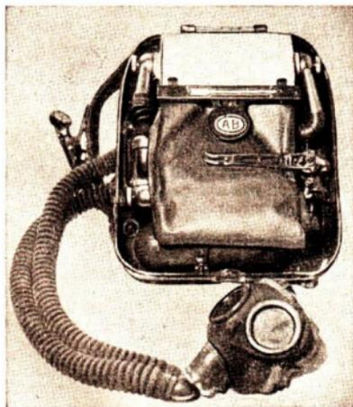
Abb. 24a Schweres Atemschutzgerät (Sauerstoffgerät unserer Feuerwehr)
