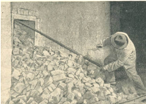
Abb. 64 Schachtofen-Abstich. In dem vollautomatischen Schachtofen und in dem Drehrostofen erfolgt der Abstich automatisch. Der Branntkalk fällt auf ein Transportband und wird zur weiteren Verwendung transportiert.
