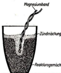
Abb. 30 Reduktion von Eisenoxyd durch Aluminium
