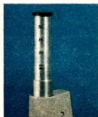
Okulartubus bis zur Marke „225 \times “ herausziehen
