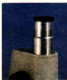
Okulartubus bleibt ganz eingeschoben „50 \times “
