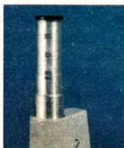
Okulartubus bis zur Marke „200 \times “ herausziehen
