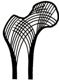
Schematische Darstellung der Hauptzug- und Drucklinien der Spongiosastruktur des Oberschenkels
