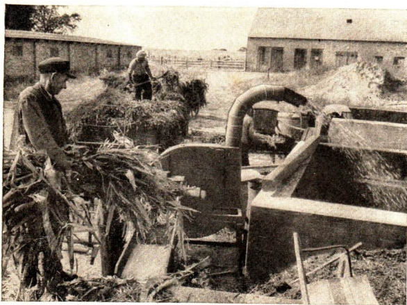
Abb. 25 Silieren von Mais und Klee. Die Häckselmaschine im Vordergrund verarbeitet den frisch geernteten Mais; die Maschine im Hintergrund häckselt den Klee
