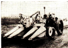
Abb. 34 Mit dieser Maschine werden sechs Rübenreihen auf einmal geköpft. Rechts: Wirkungsweise des Köpfschlittens. Das Tastrad a bewegt das Köpfmesser c nach oben und unten; b Kurbel zur Einstellung, d Blattabweiser
