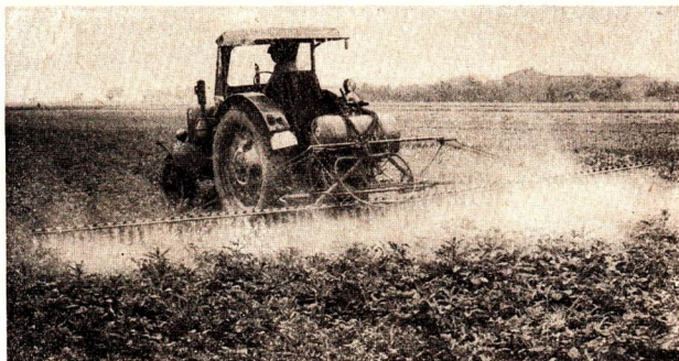
Abb. 25 Spritzgerät zur Schädlingsbekämpfung auf Kartoffelfeldern
