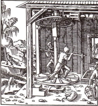
2 Eine andere Form des Tret-rades. Hiermit wurden die Erz-kübel aus dem Schacht ge-fördert
