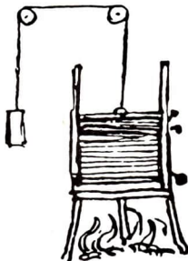
1 Entwurf zu einem Dampfversuch, gezeichnet von Leonardo da Vinci: Ein mit Wasser gefüllter Zylinder ist durch einen beweglichen Kolben geschlossen. Ein Seil führt über zwei Rollen, an ihm hängt ein Gegengewicht. Der durch Erhitzung des Wassers entstandene Dampf bewegt den Kolben nach oben 2 Handzeichnung Leonardo da Vincis: eine Buchdruckpresse
