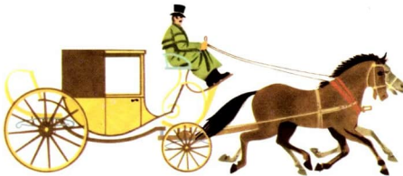
6 Der Wagenkasten dieser Kutsche war zur Federung an Tragriemen aufgehängt
