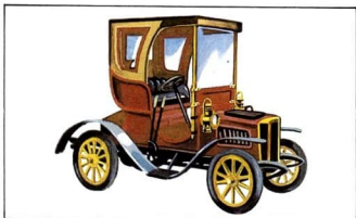
6 Dixi, Baujahr 1905, Einzylinder-Viertaktmotor, Höchstgeschwindigkeit 40 km/h
