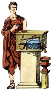
1 Blick ins Innere des Weihwasserautomaten von Heron
