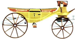
5 Der Landauer, so genannt, weil er erstmals in der Stadt Landau gebaut wurde. Er kam im 18. Jahrhundert auf und hatte bereits stählerne Tragfedern
