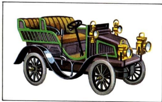
2 Wartburg-Automobil aus dem Jahre 1902. Zweizylinder-Viertaktmotor, Höchstgeschwindigkeit 40 km/h
