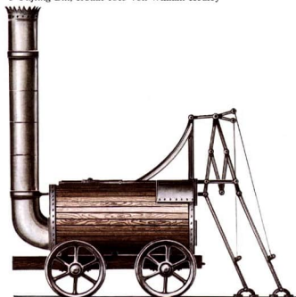
4 Lokomotive mit Stelzen, erbaut 1813 von Thomas Brunton
