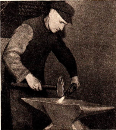
Abb. 38. Der Schmied schließt von der Glühfarbe auf die Temperatur des Eisens. Man kann sie aber auch mit einfachen Hilfsmitteln berechnen.
