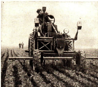
Abb. 9 IFA-Schlepper „Maulwurf“ beim Rapshacken. Der Hackrahmen ist zwischen Vorder- und Hinterrädern am Rahmen des Schleppers montiert.
