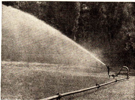
Abb. 68 Beregnungsanlage in Tätigkeit. Transportable Rohrleitung mit angeschlossnem Propeller-Regner
