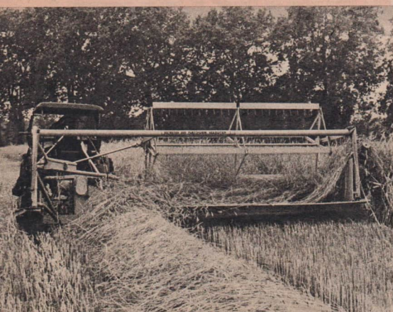
Abb. 7 Versuchsmuster eines Schwadmähers bei der Arbeit im Roggen
