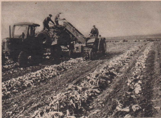
Abb. 1 Blattladegerät zum RS-09 bei der Arbeit (Blattschwad von sechs Rübenreihen)
