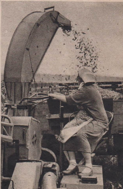
Durch ein Gebläse wird der gehäckselte Mais auf den Wagen befördert
