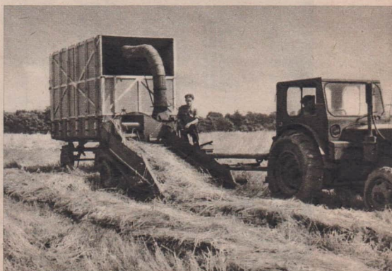
Abb. 9 Feldhäcksler beim Häckseln von Getreide aus dem Schwad
