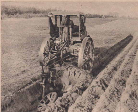
Abb. 2 Zum meliorativen Pflügen gebräuchlicher Rigolpflug CE 24 V
