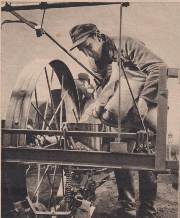
Das Jugenddorf Genschmar im Oderbruch bereitet die Maisausaat vor. Die Saatguttrommeln der sowjetischen Maislegemaschine werden gefüllt
