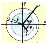
23.3-1 Abbildung durch \zeta = 1/z des Äußeren des Kreises mit Radius R auf das Innere des Kreises vom Radius 1/R
