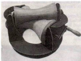
24.3-7 Modell zur Übertragung von Drehungen mittels zweier einschaliger Hyperboloide
