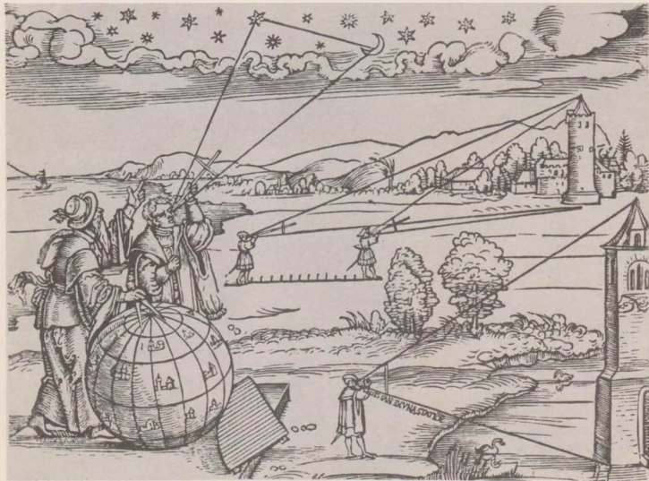
Gebrauch des Jakobstabs; zeitgenössische Darstellung aus dem 16. Jh.
