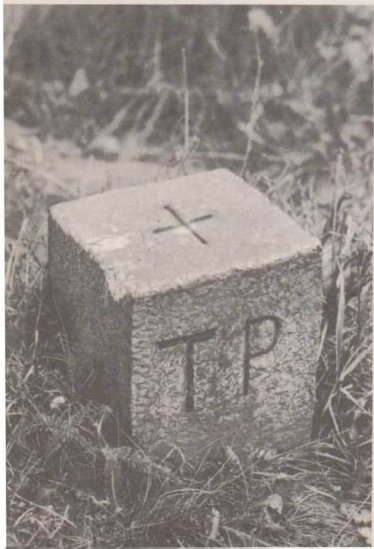
oben Signale zur Beobachtung trigonometrischer Netze
