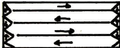
Abb. 5: Weissche Bezirke in einem ferromagnetischen Einkristall (Kristall mit homogener Struktur)
