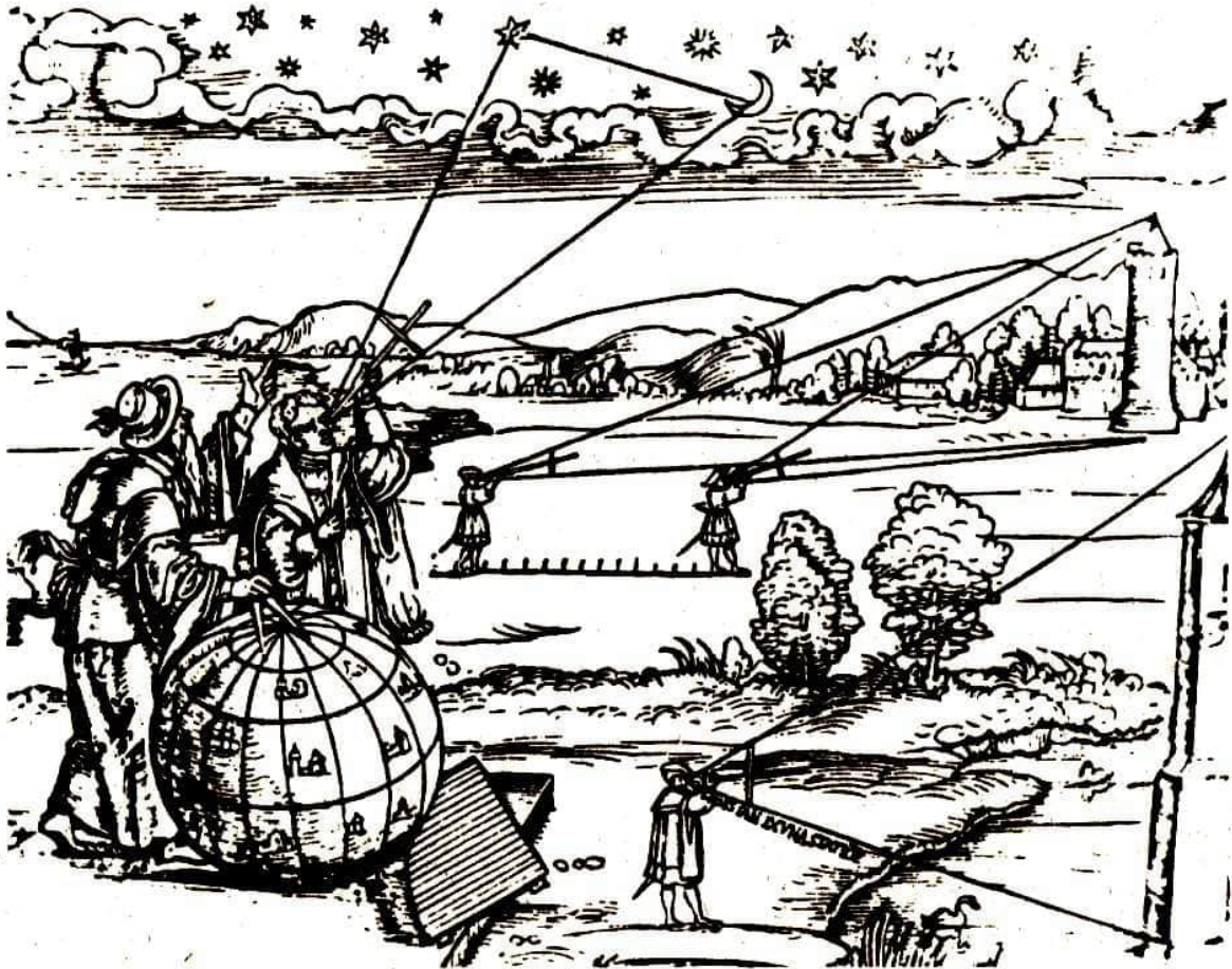
Anwendung des Jacobstabes zur geometrischen Vermessung
