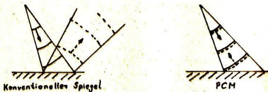
Abb.1 Reflexion einer sphärischen Welle (Kugelwelle) an einem konventionellen ebenen Spiegel und an einem PCM
