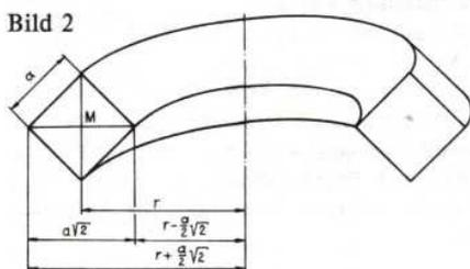
Mittelpunkt den Abstand  $r = 10$  cm hat, aber parallel zu einer Diagonalen des Quadrats verläuft (Bild 2), so ist für den entstehenden Rotationskörper die Volumenberechnung nicht mehr ganz so einfach. Man kann dazu Summen bzw. Differenzen der Volumina geeigneter Kegel verwenden.
