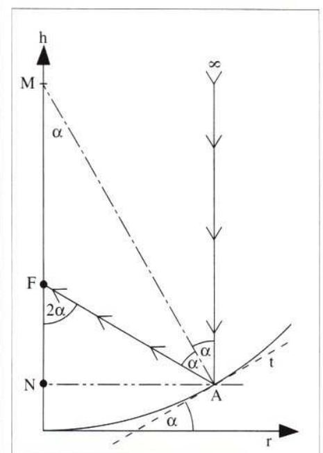
Abb. 2: Der Strahlengang zum Brennpunkt
