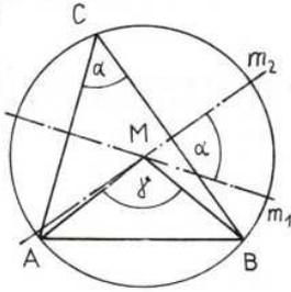
Die Spiegelung an der Mittelsenkrechten von  $\overline{AC}$  bildet  $A$  auf  $C$  ab; die Spiegelung an der Mittelsenkrechten von  $\overline{BC}$  bildet  $C$  auf  $B$  ab. Der Schnittpunkt der beiden Mittelsenkrechten  $m_1$  und  $m_2$  ist  $M$ . Durch die Drehung um  $M$  mit dem Drehwinkel
