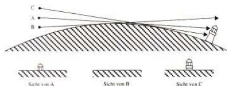
Die Wölbung unserer kugelähnlichen Erde läßt Schiffe unter dem „Wasserberg“ verschwinden. Doch „hinter“m Horizont geht's weiter“ zeigt *Walter Träger*.
