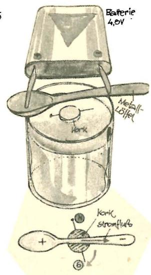
Dieses Experiment wurde (mit anderen Geräten) erstmals 1820 von dem dänischen Forscher Oersted durchgeführt. Seitdem weiß man, daß elektrischer Strom und Magnetfeld untrennbar miteinander zusammenhängen. So begann die Erforschung elektromagnetischer Erscheinungen, ohne
