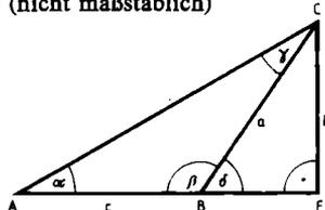
Man steckt eine Standlinie  $\overline{AB}$  so ab, daß  $A, B$  und  $F$  auf einer Geraden liegen, und mißt die Erhebungswinkel  $\sphericalangle BAC$  und  $\sphericalangle FBC$  (siehe Skizze!).
