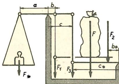
Die auf der Brücke liegende Last wirkt durch Vermittlung des Waagengestänges so, als ob sie am Hebelarm  $b$  angreifen würde.
