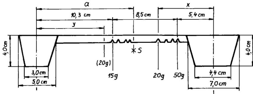
▲ 2 ▲ Zum Abwägen von 20 g Füllmittel im großen Becher ist die am Waagebalken angebrachte 20-g-Kerbe als Drehachse zu verwenden.
