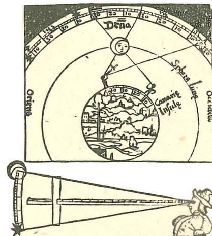
Bestimmung der geographischen Länge durch Messung von Mondabständen mittels Jakobsstab
