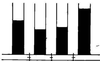
Wie hoch würde die Wassersäule in jedem dieser Gefäße stehen, wenn man die Gefäße unten verbindet, so daß sich die Höhe des Wasserspiegels ausgleicht und in allen vier Gefäßen gleich ist? (Bild 4)
