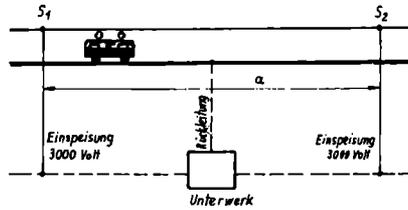
In welchen Abständen  $a$  müssen an der Fahrleitung Einspeisungspunkte von den Unterwerken des Bahnkraftwerkes vorgesehen werden, um die minimale Fahrleitungsspannung zu gewährleisten? Ing. A. Körner, Leipzig
