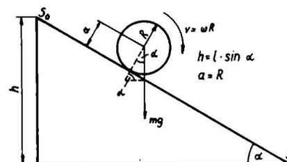
Rollkörper auf der geneigten Ebene (Kugel, Voll- und Hohlzylinder). Meßstrecke  $s-s_0$ .
