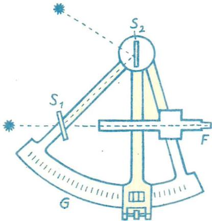
Ein einfaches Winkelmeßinstrument ist der in der Nautik zur Ortsbestimmung viel benutzte Sextant. Hier werden die Bilder zweier Sterne (oder eines Sterns und des Horizonts) mit einem festen ( $S_1$ ) und einem drehbaren Spiegel ( $S_2$ ) in einem kleinen Fernrohr ( $F$ ) zur Deckung gebracht. Der Winkelunterschied zwischen beiden Objekten kann an einem geteilten Sechstelkreis ( $G$ ) abgelesen werden.
