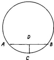
Man berechne nun den inneren Durchmesser  $d$  eines Rohres für den Fall, daß  $b = 1200$  mm und  $a = 200$  mm ist.
