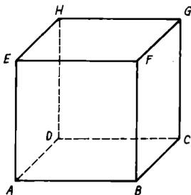
Dieser Würfel ist in senkrechter Zweitafelprojektion abzubilden. Dabei wird gefordert, daß die Raumdiagonale  $AG$  sowohl parallel zur Grundrißtafel als auch parallel zur Aufrißtafel liegt. Im übrigen kann, wenn diese Forderung erfüllt wird, die Lage des Würfels im Raum beliebig gewählt werden. Alle Eckpunkte sind entsprechend des Bildes zu benennen.
