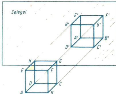
Bild 2: Gegenstand und Bild in schräger Parallelprojektion
