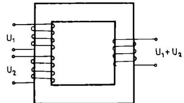
Addition mit Hilfe eines Transformators
