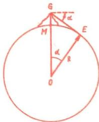
Bild 1: Schema zum Messen des Erdradius nach *Biruni*.
