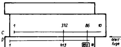
Proportionaleinstellung des Rechenstabs beim Lösen einer Verhältnisgleichung
