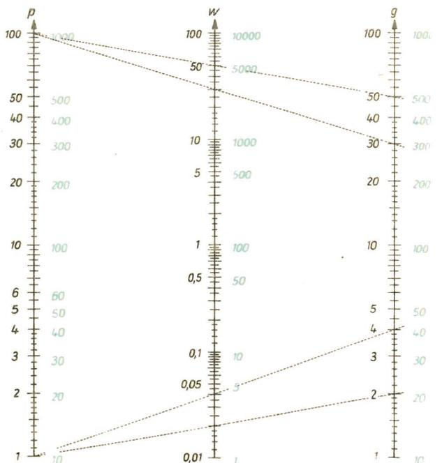
Mittellinie und Grundseiten eines Trapezes (In der Abb. S. 110, Mitte, schraffiert.) sowie daraus, daß die  $w$ -Leiter ein Bild der Skale  $B$  des Rechenstabes im Maßstab 1:2 ist.
