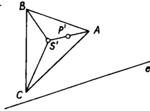
Es sind die Grundrisse der Schnittpunkte  $Q$  und  $R$  von  $\varepsilon$  mit den Pyramidenkanten  $\overline{BS}$  und  $\overline{CS}$  zu konstruieren.
