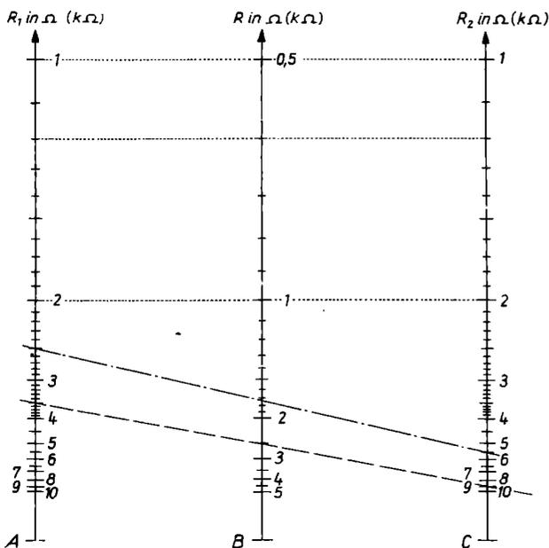
wir bei geeigneter Wahl der Längeneinheit und des Abstandes der drei parallelen Leiter das Nomogramm zeichnen. Die Kotierung der  $z$ -Leiter kann dabei auf Grund der folgenden Bemerkung zeichnerisch festgelegt werden: Für  $R_1 = R_2$  folgt aus
