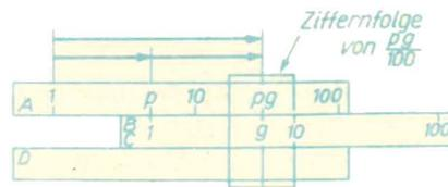
Die Strecke, die die Punkte mit den Koten 1 und  $pg$  der Skale A zu Endpunkten hat, ist gleich der Summe der Strecken, die die Punkte mit den Koten 1 und  $p$  der Skale A bzw. mit den Koten 1 und  $g$  der Skale B zu Endpunkten haben. Diese Streckenrelation benutzen wir zum Nachweis, daß unser Ansatz zum Ziele führt: Wir ergänzen die obige Abb. durch eine  $w$ -Leiter, die ein Bild der schon gezeichneten  $p$ - und  $g$ -Leiter im Maßstab 1:2 ist.
