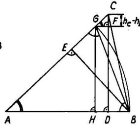
Nun suchen wir nach einer Konstruktionsmöglichkeit für den Punkt  $B$ . Er liegt auf dem Kreis mit  $a$  um Punkt  $C$ . Es fehlt aber noch eine zweite Angabe. Ein Blick auf die Figur zeigt, daß er außerdem auf der Geraden durch  $G$  und  $B$  liegen muß. Für diese Gerade läßt sich aber die Richtung konstruieren, denn offensichtlich ist  $GB$  Winkelhalbierende des Winkels  $\sphericalangle FGA$ . Jetzt können wir den 1. Teil der Lösung formulieren:
