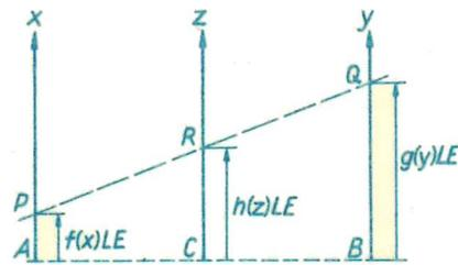
Wir erarbeiten uns die Antwort:  $(x; y; z)$  sei ein Lösungstriple. Dann liegen die den Zahlen  $x, y$  und  $z$  zugeordneten Leiterpunkte  $P, Q$  und  $R$  auf einer Geraden. Unter der zusätzlichen Annahme  $f(x) > 0, g(y) > 0$  und  $h(z) > 0$  ist  $CR$  Mittellinie im Trapez  $ABQP$ .
