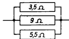
*Lösung:* Zunächst wird der Gesamtwiderstand von zwei parallel geschalteten Widerständen, etwa von  $3,5\Omega$  und  $9\Omega$  zu  $2,5\Omega$  (Gestrichelt markierte Gerade der obigen Abb.) ermittelt. Anschließend wird noch der Gesamtwiderstand der parallel geschalteten Widerstände von  $2,5\Omega$  und  $5,5\Omega$  zu  $R = 1,7\Omega$  (Durch Punkte und Striche markierte Gerade der obigen Abb.) bestimmt.
