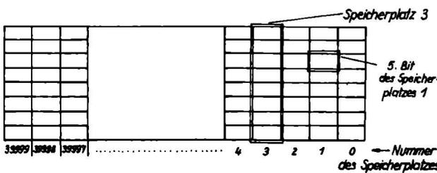
Jede Spalte des Speichers heißt *Speicherplatz* und besteht aus acht übereinanderliegenden *Bits*. Hinter jedem Bit denke man sich also einen (ringförmigen) Ferritkern mit folgenden beiden möglichen Magnetisierungszuständen:
