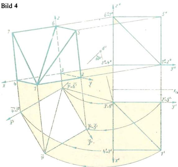
Der Vorzug dieser Konstruktion besteht darin, daß man, von Grund- und Aufriß eines räumlichen Objektes ausgehend, mit geringem Zeit- und Konstruktionsaufwand ein anschauliches axonometrisches Bild des Körpers neben den zugeordneten Normalrisse erhält. Die sich zwanglos ergebende
