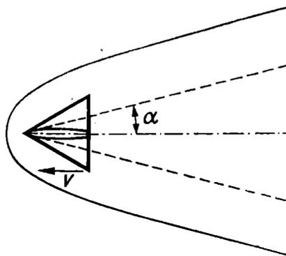
Abgehobene Kopfwelle vor einem mit Überschallgeschwindigkeit fliegenden Flugzeug
