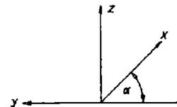
Da der Betrachter meist eine Zeichnung senkrecht zur Blickrichtung hält, erscheinen orthogonalaxonometrische Bilder weniger verzerrt als schiefaxonometrische. Sehr gebräuchliche orthogonale Axonometrien, die Dimetrie und Isometrie, sind durch folgende Angaben bestimmt:
