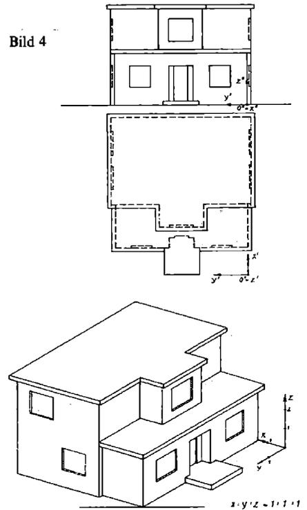
Das Verhältnis  $x : y : z = 1 : 1 : 1$  bedeutet, auf allen drei Achsen sind gleiche Längeneinheiten gewählt worden. In der Praxis werden oft die beiden schiefen Axonometrien, Militärperspektive und Kavalierverspektive, verwendet. Für sie gilt:
