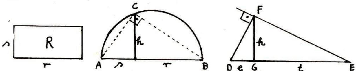
Erster Schritt: Verwandlung von  $R$  flächengleich in ein Quadrat  $Q$ . (Vgl. Abb. 4:  $rs=h^2$ , Höhensatz, Konstruktion von  $\triangle ABC$  mit Thaleskreis).
