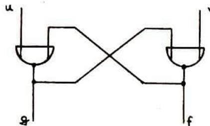
$(f, g)$  ist der innere Zustand des Flip-Flops in dem Moment, in dem die Eingangsbelegung  $(u, v)$  angelegt wird.  $(f', g')$  ist der innere Zustand, der sich daraufhin einstellt. Die Eingangsbelegung  $(1, 1)$  sowie die inneren Belegungen  $(0, 0)$  und  $(1, 1)$  sind verboten, da sie zu Wettlauferscheinungen führen, so daß der sich einstellende innere Zustand zufällig wird.
