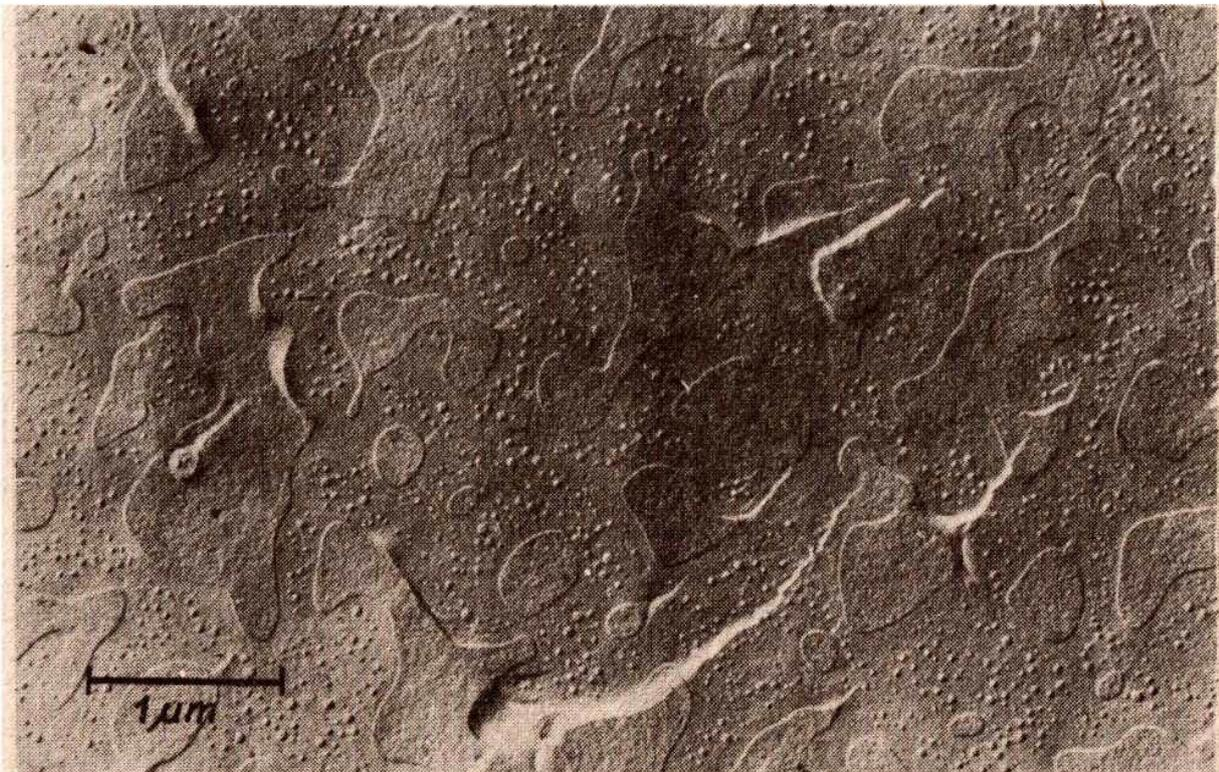
Elektronenmikroskopische Aufnahme des Pt/Ir/C-Abdruckfilms der Bruchfläche eines mehrfach entmischten Natriumborosilikatglases. Die Probe ist visuell völlig getrübt. Diese Aufnahme zeigt, daß die geometrische Gestalt der glasigen Produkte einer Mikrophasentrennung nicht immer kugelförmig ist.
