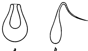
Abb. 3.2.8./1 Schnell gekühlte Gläser: a) Bologneser Fläschchen, b) Glasträne
