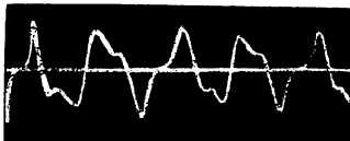
Abb. 7.2.9./3 Überlagerung zweier gleichgerichteter Schwingungen, aufgezeichnet durch ein Sandpendel
