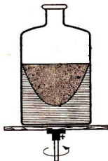
Abb. 6.1.9./1 Verteilung einer Flüssigkeit in einer Flasche. Die Flüssigkeitsoberfläche bildet ein Rotationsparaboloid.
