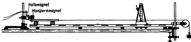
Abb. 4.1.7./1 Versuchsaufbau zur Untersuchung der gleichförmigen geradlinigen Bewegung mit dem Schienenwagen. Die Reibungskraft wird durch die Gewichtskraft eines Hakenkörpers kompensiert.
