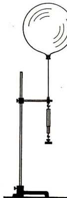
Abb. 2.4.2./1 Ein an einem Kraftmesser befestigter, mit Gas gefüllter Kinderballon zur Bestimmung seiner Auftriebskraft
