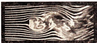
Abb. 4.2.5./3 Wirbelstraße hinter einer Platte
