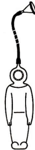
Abb. 1.4.19./2 Plastpuppe mit der Form eines Tauchers. Bläst man Luft durch den Schlauch in die Plastfigur, dann steigt sie im Wasser empor
