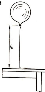
Abb. 2.4.3./1 Mit Stadtgas gefüllter Ballon. Die Auftriebskraft des Ballons ist gleich der Gewichtskraft der gehobenen Schnur.
