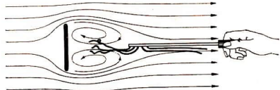
Abb. 4.2.4./4 Mehrfadensonde im Luftstrom hinter einer Kreisscheibe
