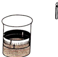
Abb. 2.4.3./2 Versuchsanordnung zur Ermittlung des Brechungsgesetzes unter Verwendung eines Becherglases
