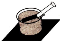
Abb. 2.4.4./3 Beobachtung der Totalreflexion des Lichtes bei einem in Wasser eingetauchten luftgefüllten Reagenzglas
