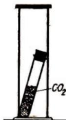
Abb. 3.2.3./3 Explosion eines Reagenzglases durch Sublimieren von Kohlendioxidschnee
