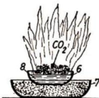
Abb. 3.2.3./2 Löschen einer Flamme durch Kohlendioxidschnee
