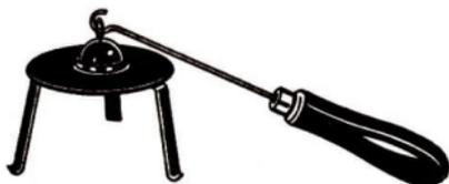
sierklinge gesteckt. Der Metallstab kann mit der Flamme eines Brenners oder einer Kerze erwärmt werden (Abb. 2.1.1./3). Der Stab dehnt sich beim Erwärmen aus. Dadurch verbiegt er die Rasierklinge. Das Trinkröhrchen zeigt das Deformieren an.
