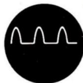
Abb. 5.3.4./3 Oszillogramm des pulsierenden Gleichstroms
