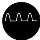
Abb. 5.3.4./3 Oszillogramm des pulsierenden Gleichstroms
