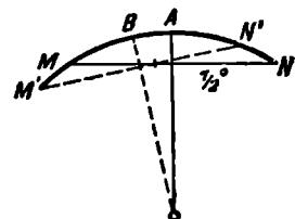
Das Bläschen entfernt sich von dem Markierungspunkt (richtiger: der Markierungspunkt vom Bläschen) etwa 9 mm, also nahezu einen ganzen Zentimeter. Man erkennt leicht, daß die Wasserwaage um so empfindlicher ist, je größer der Radius für die Krümmung des Röhrchens ist.
