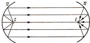
Abb. 3.2.13./2 Konzentrierung des Wellenbündels auf den Empfangsdipol
