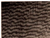
Abb. 2.1.5./5 Mikrofotografische Aufnahme des Luftkeils zwischen einer Planglasplatte und einer Placrylplatte
