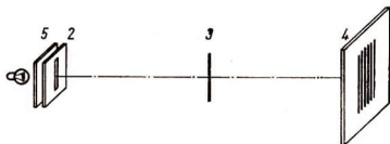
Abb. 2.2.1./1 Versuchsanordnung zur Beugung des Lichtes an einem schmalen Hindernis
