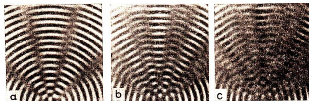
Abb. 1.2.10./3 a, b, c Abhängigkeit der Interferenzen von der Anzahl der Erregerzentren
