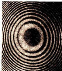
Abb. 2.1.5./2 Newtonsche Ringe im reflektierten Natriumlicht
