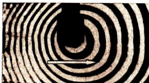
Abb. 1.2.9./1 Doppler-Effekt an Oberflächenwellen; ruhender Erreger, bewegtes Medium
