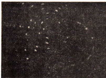
Abb. 9.4.1./2 Laue-Diagramm eines Natrium- thiosulfatkristalls (Anodenspannung 30 kV, Stromstärke 3 mA, Bestrahlungszeit 1h)
