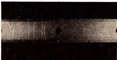
Abb. 9.4.2./2 Debye-Scherrer-Diagramm eines Kupferdrahts (Anodenspannung 30 kV, Stromstärke 3 mA, Bestrahlungszeit 1 h)
