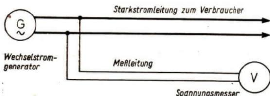
Bild 52/1: Direkte Übertragung des Meßwertes „Spannung“
