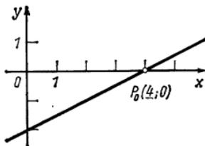
Der Nullstelle der Funktion entspricht in der graphischen Darstellung die Abzisse des Schnittpunktes mit der Abszissenachse
