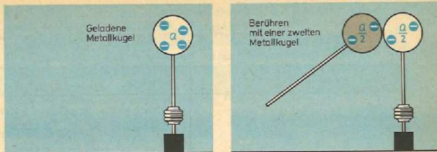
Ladungsteilung bei zwei gleich großen, elektrisch geladenen Metallkugeln
