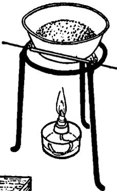
Wir legen also ein Drahtdreieck auf einen Dreifuß oder einen Kochring des Experimentierstativs und hängen eine Porzellanschale mit lufttrockener Erde ein. Zunächst treiben wir mit einer kleinen Flamme das auch dem lufttrockenen Boden noch immer anhaftende Wasser aus; das dauert eine geraume Zeit. Dann rücken wir mit dem Brenner näher unter die Schale oder regulieren eine größere Flamme ein. Die jetzt aufsteigenden Dämpfe stammen aus dem Humus. An einer darübergehaltenen Glasscheibe schlagen sich
