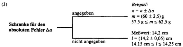
Nach diesen systematisierenden Betrachtungen sollten weitere Aufgaben zur Berechnung von Fehlern und zur Angabe von Schranken für den absoluten Fehler bzw. von Intervallen, in denen der genaue Wert liegt, gelöst werden.
