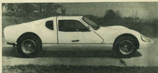
Rennsportwagen RS 1000 , Dreizylinder-Zweitaktmotor; Hubraum: 992 cm 3 ; Höchstleistung: 70 PS (51 kW) bei 4500 U/min, 90 PS (66 kW) mit Rennvergaser; Höchstgeschwindigkeit: 165 km/h
