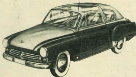
Nur als Prototyp gebaut: Wartburg Bellevue von 1957. (900 cm 3 , 27 kW bzw. 37 PS bei 4000 U/min, 115 km/h)
