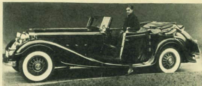
Horch Cabriolet Typ 670; Baujahr: 1931 bis 1934; 12-Zylinder-Motor; Bohrung × Hub: 80 × 100 mm; Hubraum: 6021 cm 3 ; Leistung: 120 PS (88 kW); Geschwindigkeit: 140 km/h
