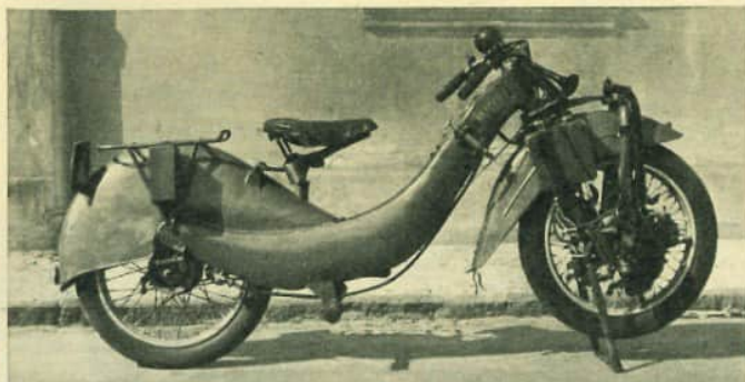
Ursprünglich wurde das Hinterrad der „Megola“ an Blattfedern geführt. Deutlich sichtbar aber der originelle Fünfcylinder-Sternmotor im Vorderrad.
