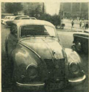
Der IFA-F 9, zweitaktender Vorgänger des Wartburg 311. (900 cm 3 , 21 kW bzw. 28 PS bei 3600 U/min, 115 km/h)
