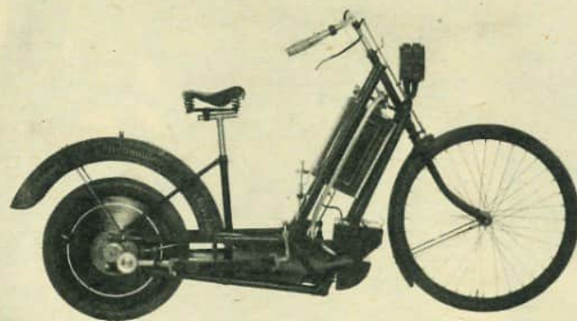
Der hintere Kotflügel der „Hildebrand & Wolfmüller“ war als Kühlwasserbehälter ausgebildet.
