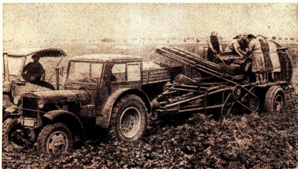
Abb. 16 Kartoffelvollerntemaschine E 372 bei der Arbeit. Die Maschine wird von einem Traktor über das Feld gezogen, der die Maschine gleichzeitig antreibt. Neben der Vollerntemaschine fährt ein Traktor mit Anhänger, auf den die geernteten Kartoffeln befördert werden. Die Arbeiterinnen lesen Steine und dergleichen aus. Mit der Vollerntemaschine lassen sich täglich 2 bis 3 Hektar Kartoffeln ernten.
