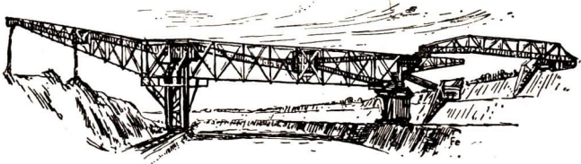
Abb. 103. Die Abraumförderbrücke überspannt den Braunkohlentagebau. Rechts wird durch 2 Tiefbagger das Deckgebirge abgetragen, auf Transportbänder geschüttet und von diesen nach links gebracht dort wird es auf das ausgekohlte Gelände verstrzt
