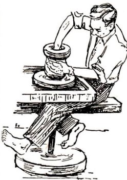
Abb. 146. Formen eines Hohlgefäßes auf der Töpferscheibe
