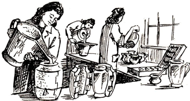
Abb. 147. Gießen von Porzellangegenständen. Links wird dünnflüssiger Gießschlicker in die Gipsform eingegossen. Der überflüssige Gießschlicker wird im Hintergrunde wieder ausgegossen. Dann öffnet man die zweiteilige Gipsform (Vordergrund), nimmt das Gußporzellan heraus und klebt die in gesonderten Formen hergestellten Henkel mit dünnflüssiger Porzellanmasse an (rechts).
