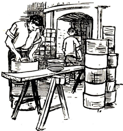
Abb. 148. Einsetzen des geformten Porzellans in Schamottekapseln, die im oberen Teile des Porzellanofens aufgestapelt werden
