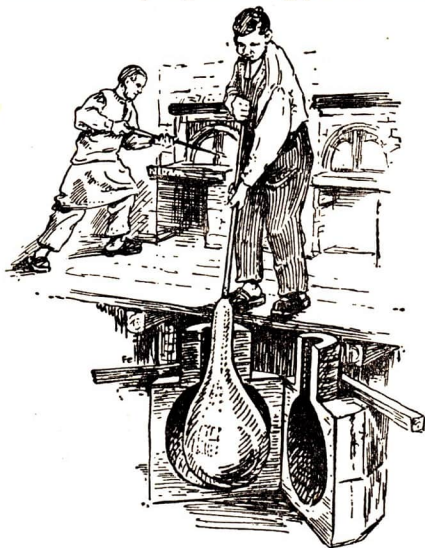
Abb. 141. Glasbläser beim Blasen eines Kolbens. Im Hintergrunde wird Glasfluß mit der Glasbläserpfeife aus dem Schmelzofen entnommen. Der Kolben wird in eine zweiteilige, zuklappbare Hohlform hineingeblasen.
