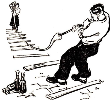
Abb. 142. Glasbläser beim Ziehen von Glasröhren. Der wachsweiche Übergangszustand des Glasflusses ermöglicht die ausgeprägte Streckung. Durch das Einblasen von Luft in den Glasfluß wird aus dem massiven Glasstab eine Glasröhre.
