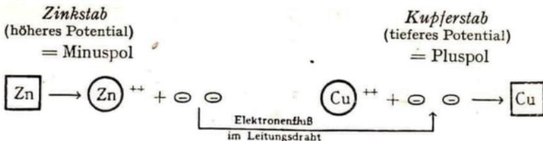
Wir haben ein *galvanisches Element* (ein Daniell-Element) vor uns, dessen Potentialdifferenz durch Einschalten eines Voltmeters zwischen die beiden Elektroden gemessen werden kann. Die Potentialdifferenzen der verschiedensten Kombinationen lassen sich auf diese Weise messen, wobei wir als Nullpunkt das Potential einer Wasserstoffelektrode wählen.
