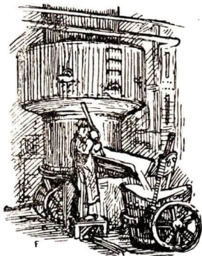
Abb. 168. Abstich des Kupolofens.
