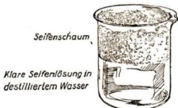
Abb. 198. Seifenwirkung in destilliertem Wasser. Es bildet sich ein kräftiger Seifenschaum über einer klaren Seifenlösung
