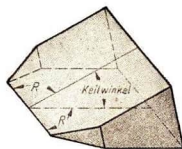
Abb.65. Der Keilwinkel beim Kreuzmeißel
