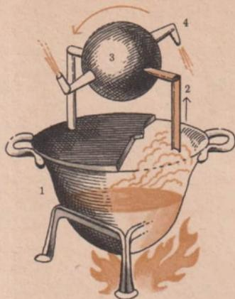
Die Aeolipile des Heron (1 Dampfkessel mit Deckel, 2 Dampfrohr, 3 drehbar gelagerte Hohlkugel, 4 rechtwinklig gebogene Abdampffröhchen)
